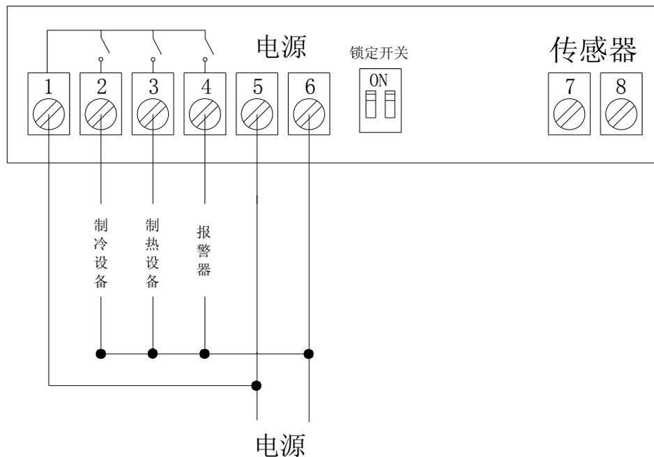
接线柱 1 和 2: 制冷输出
